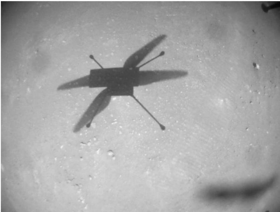
Grâce à une petite fenêtre météo calme le 7 février dernier, le vol 19 a finalement pu avoir lieu dans des conditions acceptables. Tout s'est bien déroulé avec une distance parcourue de 63 mètres et une altitude de 10 mètres, à une vitesse de 1m/s et une durée de 1 minute et 40 secondes.
